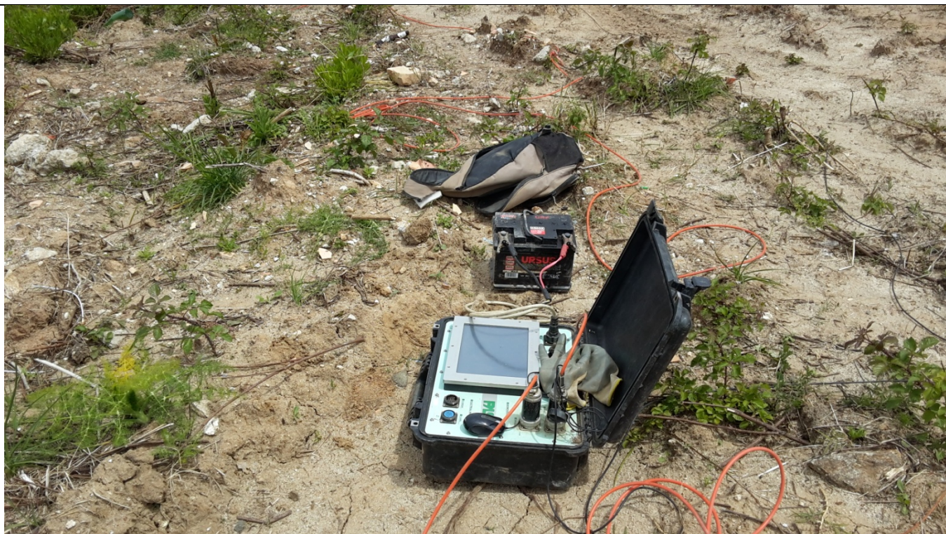
Prospezione sismica a rifrazione e MASW
